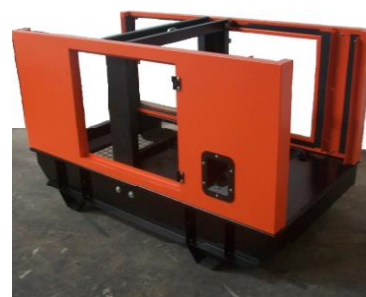
MONTAJE DE LATERALES MONTAGE DES DEUX COTE ASSEMBLY OF BOTH SIDES
